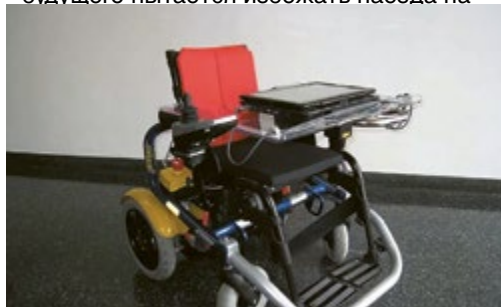
Кресло для инвалида, реализующее функции assisted robotics
