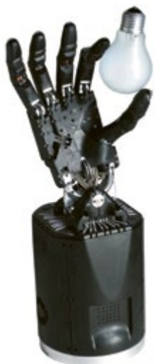
Манипулятор, созданный компанией Shadow Robot, имеет 20 степеней свободы
