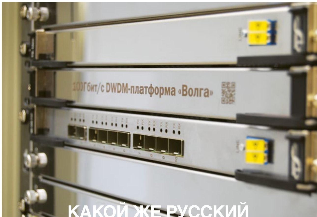
Это оборудование объединяет 10 каналов по 10 Гбит/с и передает их в одном 100 Гбит/с DWDM-канале. Фото предоставлено Т8
