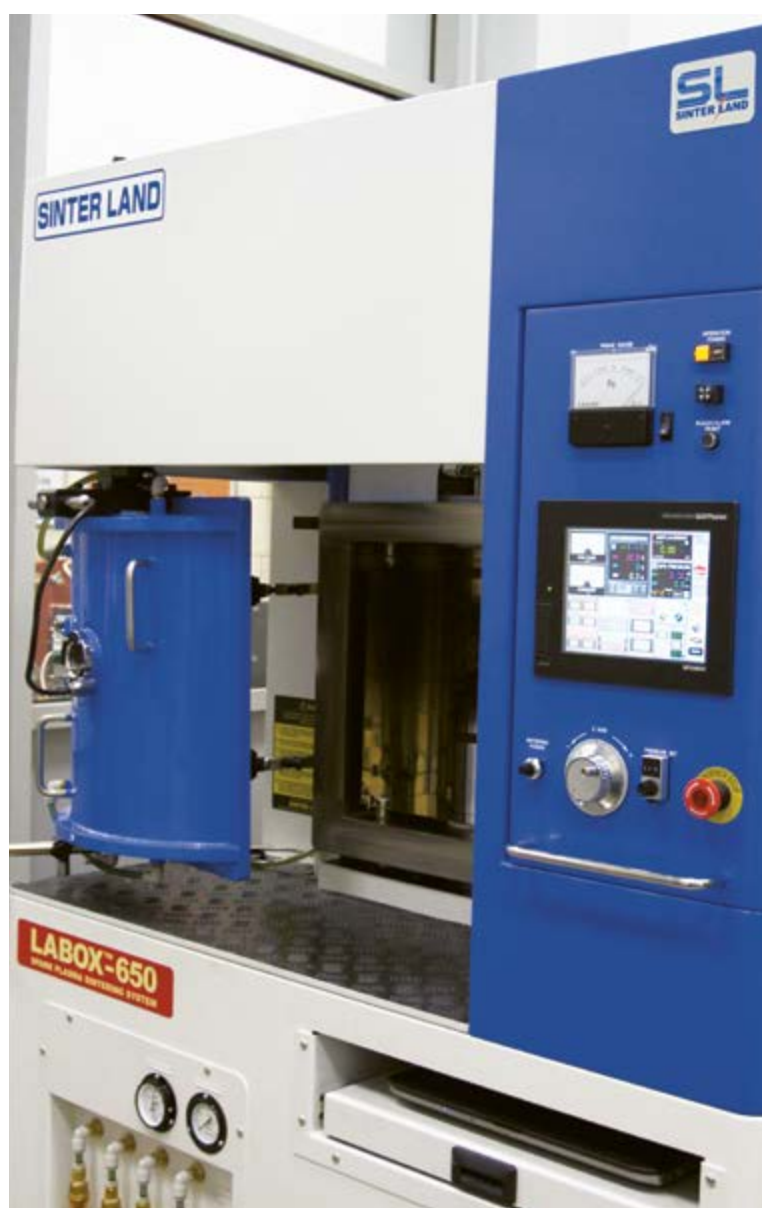
Установка искрового плазменного спекания. Фото из личного альбома А. Воронина
