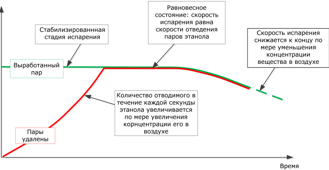
Рисунок 38: Эффективность влияния систем вентиляции на концентрацию паров этанола в воздухе
