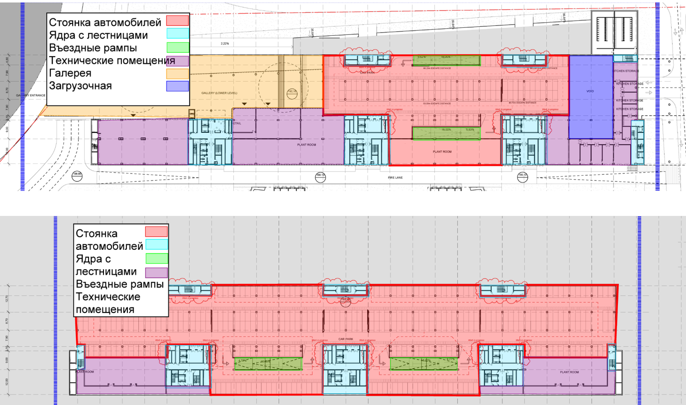
Рисунок 4: Подвал северного сектора – 1-й надземный этаж и подземный уровень -02
