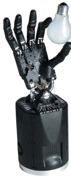
РИС. 4. ▶ Манипулятор, созданный компанией Shadow Robot, имеет 20 степеней свободы
