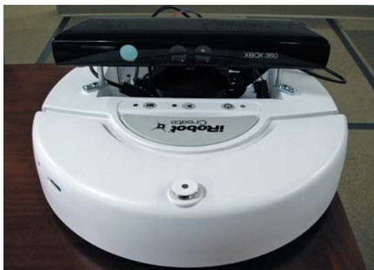
РИС. 7. ▼ Использование сенсора Microsoft Kinect, интегрированного с платформой Create компании iRobot
