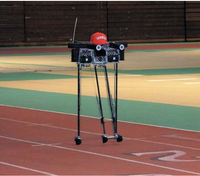
РИС. 2. ▲ Робот Рейнджер, придуманный в Университете Корнелл, сумел пройти марафонскую дистанцию без подзарядки 12
