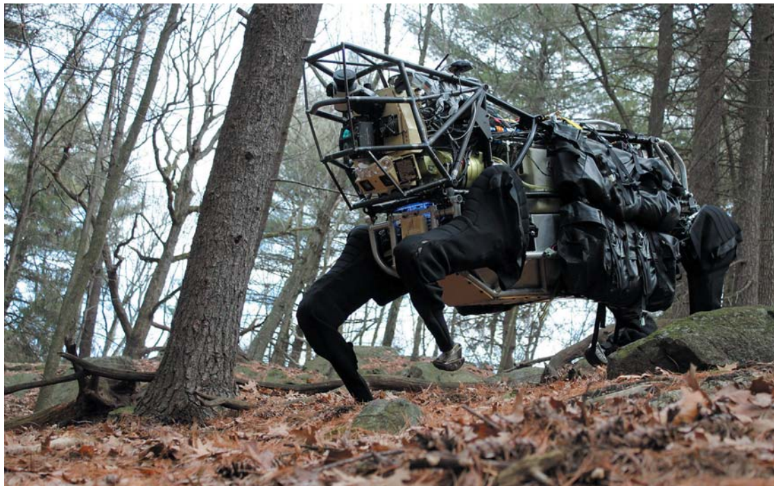
РИС. 6. ▶ Робот Big Dog, разработанный компанией Boston Dynamics 15 , использует двигатель внутреннего сгорания
